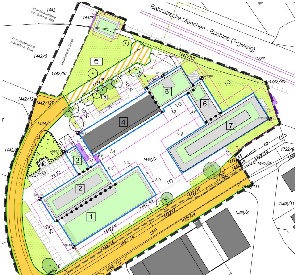
Abb. 8: Bereiche mit möglicher Unterschreitung der Abstandsflächen 0,4 H bzw. mind. 3 m gemäß vorliegendem Bebauungsplan am Alois-Harbeck-Platz (lila markiert), die bemäßen Abstandsflächen berücksichtigen die erhöhte Lage des Platzes.
